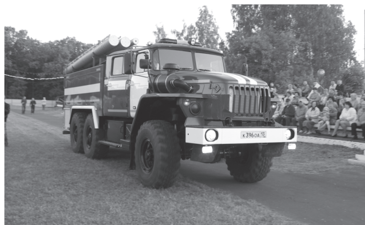
Пожарная часть Рузаевского района получила в День России подарок – новую автоцистерну на базе «Урала». Её вместимость – 5,5 т воды и 360 л пенообразователя. Машина укомплектована современным пожарно-техническим вооружением, а насос управляется электроникой. Теперь в Рузаевской пожарной части 5 автоцистерн и 1 автолестница.
