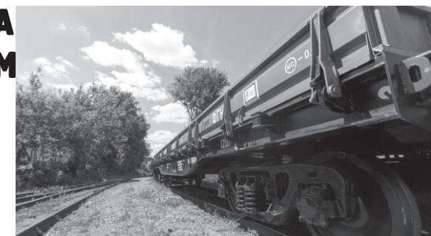
Вагон-платформа производства РМ Рейл Рузхиммаш предназначена для транспортировки колесной и тяжелой гусеничной техники, металлоконструкций, крупнотоннажных контейнеров, контейнеров-цистерн для опасных грузов массой брутто до 36 т. Также платформа может перевозить насыпные, навалочные и лесные грузы, не требующие защиты от атмосферных осадков.
