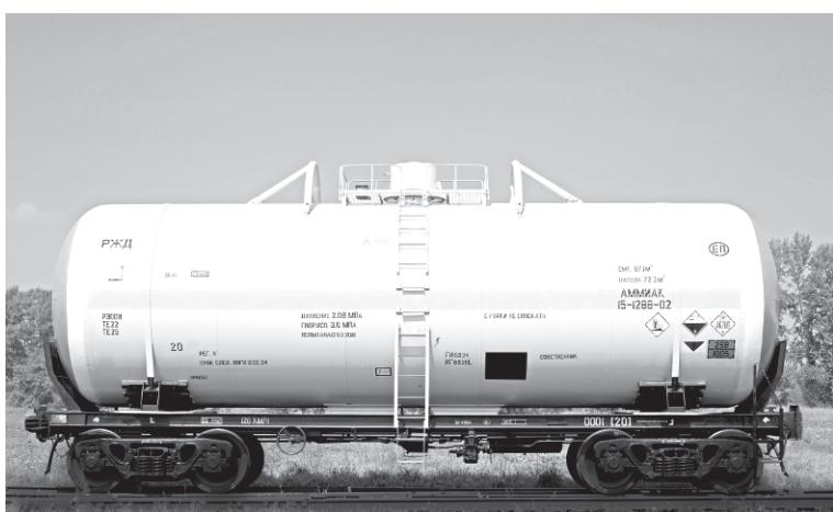
«РМ Рейл» вывела на рынок новый вагон-цистерну для перевозки аммиака с увеличенным до 87 куб. м объемом котла. Цистерна может перевозить на 17 процентов больше груза, чем аналогичные модели. Величина котла является максимальной для габарита 1-Т.
